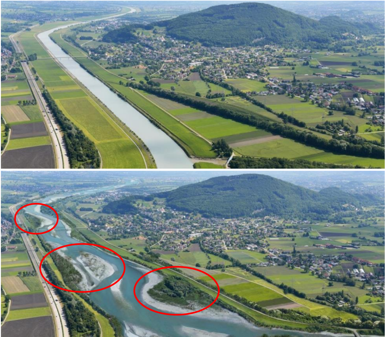
Abbildung 6: Visualisierung der Rhein-Revitalisierung an der Frutzmündung bei Koblach, resp. Oberriet SG. Das terrestrische Monitoring berücksichtigt die Bereiche bis zu den geplanten äusseren Dämmen. Die roten Kreise umfassen die Schwerpunktbereiche dieses Projektes. Die Veränderungen in diesen Bereichen sollen deshalb mit dem geplanten Monitoring überwacht und mit anderen Stellen verglichen werden können. Copyright: IRR – Internationale Rheinregulierung. www.rhesi.org
