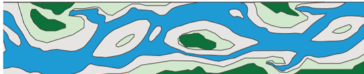
Abbildung 4: Vom Kanal zurück zum revitalisierten, naturnahen Gewässer: Erst mit zunehmender Breite des Gewässerräum es können sich wieder terrestrische Auenlebensräume etablieren und es bilden sich Inseln mit Pionierv egetation, Weichholz- oder sogar Hartholzauenwälder. Grafik Schälchli 2016, Rey & Boller 2016, ergänzt.
